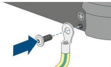
3. Baldes metálicos não aterrados podem gerar faíscas em Contato com a pistola do equipamento.
