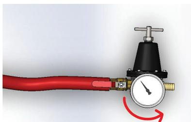
5. Com o gatilho da pistola apertado e apontado para um reservatório, Rodar o botão de ajuste do regulador e verificar no manómetro a pressão, fazer a circulação do produto na mínima pressão possível
