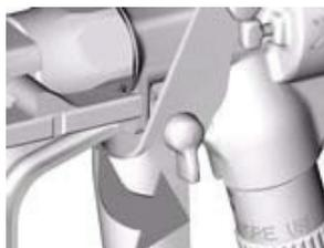
2. Fechar a válvula pneumática de entrada de ar.
