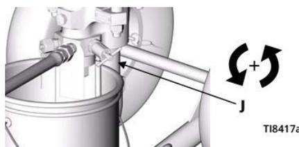
\*Caso haja suspeita de o bico ou mangueira estarem totalmente obstruídos, abrir lentamente a válvula de retorno voltando ao balde, assim que estiver retirada toda pressão do equipamento conferir Mangueira e pistola.
