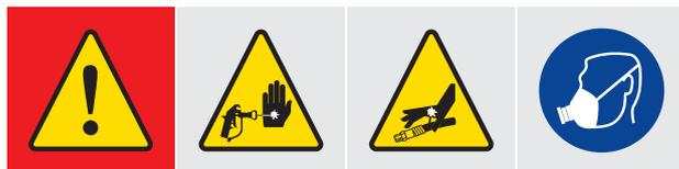
A pulverização de alta pressão pode injetar material no corpo humano, o que é um sério perigo. Não interrompa os vazamentos com a mão ou um pano!
