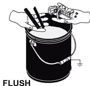
5. Posicione o pescador em balde de metal aterrado completo com fluido de limpeza. Faça a Inicialização (passos 6-8 / pág. 6). Limpe a tinta na máquina. Para tinta base d'água, limpeza com água. Solvente para base de solvente.
