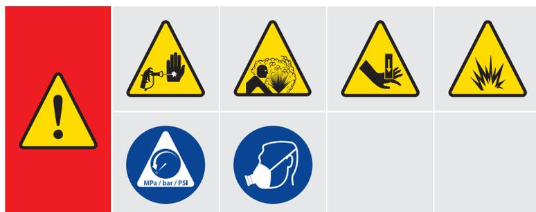
O equipamento está sob alta pressão interna antes de ser despressurizado. O fluido de alta pressão pode causar ferimentos graves. Antes de verificar, mover ou reparar o equipamento, siga o procedimento de despressurização deste manual.
